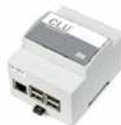
CLU Com Dynamisk lastbalansering Styrning via GPRS.
