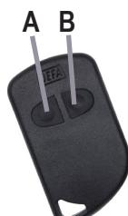
**Med bilens original fjärrkontroll:** DEFA AutoSecurity billarm styrs med lås/öppna-knapparna. När fjärrkontrollen nyttjas till att låsa bilen kommer larmet samtidigt att slås PÅ.
