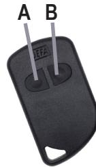
Et kort tryk - betyder at du trykker på knappen i maksimalt 1 sekund. Et langt tryk - betyder at du trykker i minimum 2 sekunder. Oplåsning ved hjælp af nøgle i dørlåsen vil ikke slå alarmen fra.
