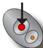
Aktiverat stöldskydd indikeras med en kort blink varje sekund via lysdioden i kodpanelen. När stöldskyddet är aktiverat kan båtens motor inte längre startas.
