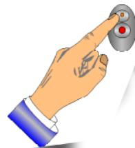
Na het invoeren van het vierde cijfer schakelt de startblokering zichzelf na een paar seconden uit, als tenminste de juiste code is ingevoerd! Als u de verkeerde code hebt ingegeven (bijv. een verkeerd tweede cijfer), moet u nog steeds de rest van de code invoeren, of 20 seconden wachten om opnieuw te beginnen vanaf punt 1.
