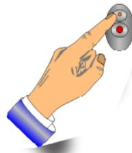
Efter det 4. ciffer er tastet ind, deaktivieres startspærren i løbet af et par sekunder, under forudsætning af, at det er den rigtige kode!! Hvis du taster en forkert kode ( f.eks. taster forkert med det andet ciffer) skal du stadig taste kode færdig, eller vente i 20 sekunder for derefter at starte forfra fra punkt 1.
