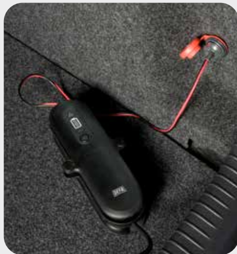
Gjennom en 12V ladeplugg kan du både lade batteriet og enkelt hente ut strøm når du trenger det.
